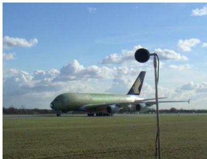
Messung Triebwerks- geräusche, Airbus Hamburg
